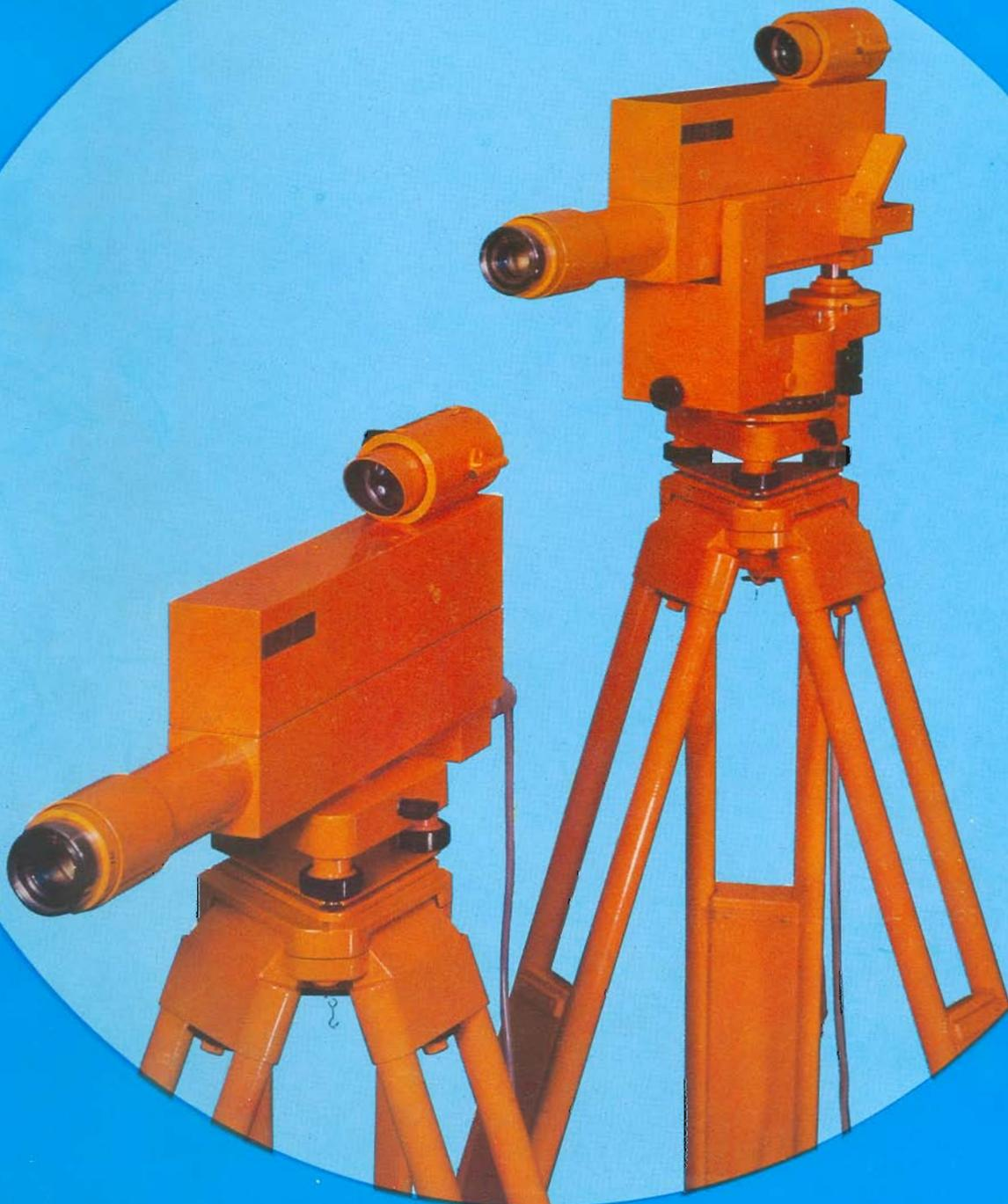
Die Laserfluchtungsgeräte LF 1 und LFG 1 erzeugen eine aktive Referenzlinie oder -ebene für die Aufgaben des Vermessungs- oder Bauwesens, bei denen Bauteile oder Meßpunkte auf ihre geradlinige Anordnung hin überprüft werden müssen, z. B. im
